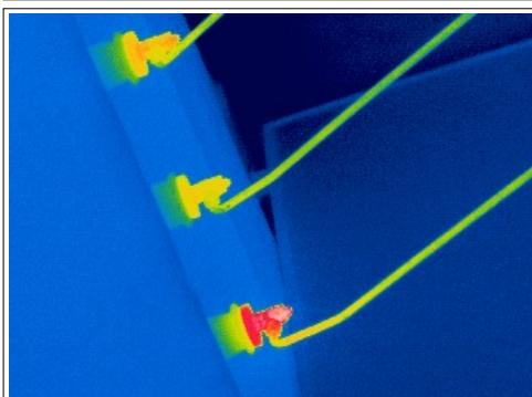
Limpiar el contacto de el alambrón con el terminal del pasamuros no permitirá que la conexión del alambrón en otros sectores de la misma fase terminen con el mismo final.
