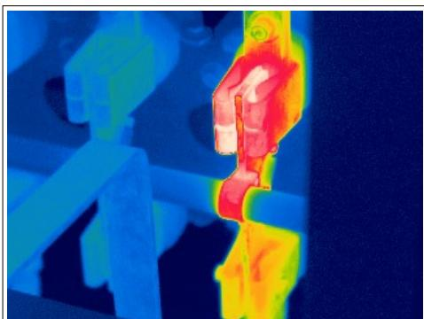
Limpiar los contactos de la cuchilla con la mordaza no permitirá afectar físicamente al seccionador como así tampoco al conductor de conexión.
